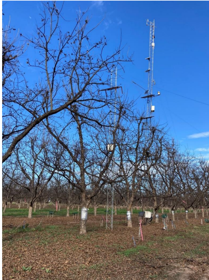
Figura 1. Torre micrometeorológica en nogal pecanero, Viñas de Costa, Hermosillo, México.
